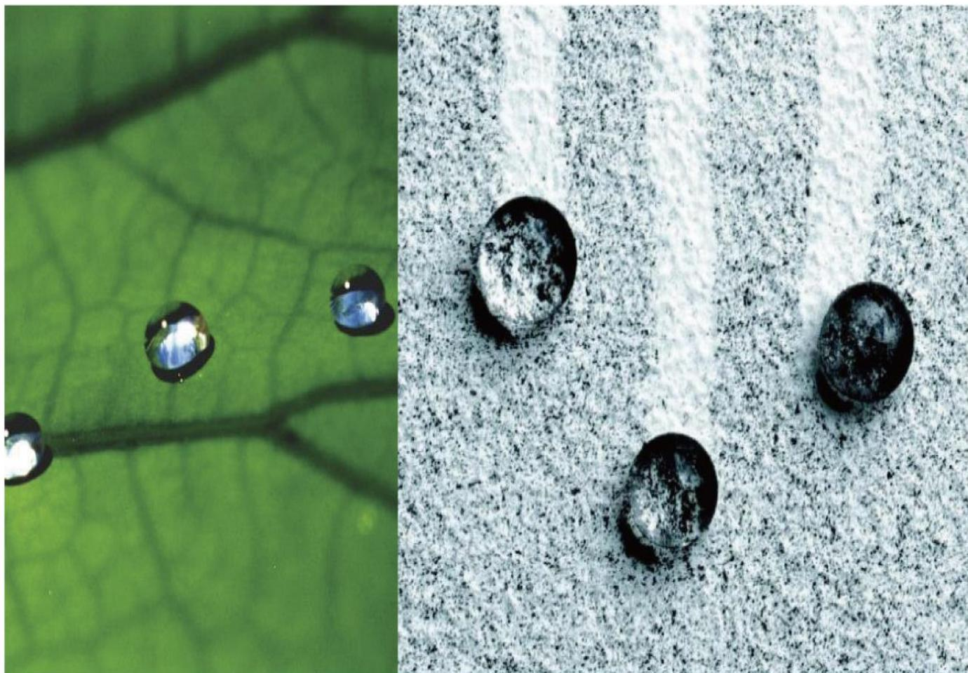
「自浄作用」超撥水性の表面 ➡ ミクロ／ナノ構造 + 疎水性表面の化学作用
