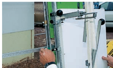
Sto EPSボード ino cut ® 用熱線カッター
